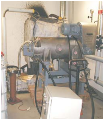
Mobiles Aufbereitungssystem bestehend aus Arbeitstank, Ultraschall-System & Dekanter
