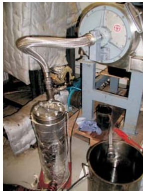
Mobiles Aufbereitungssystem bestehend aus Arbeitstank, Ultraschall-System & Dekanter
