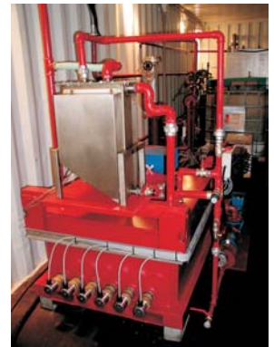
Mobiles System für Aufbereitung von 500 Liter Slop Oil
