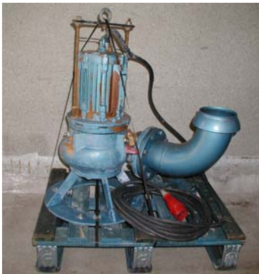
Eingesetzte Zerhackerpumpe für Versuche ES-J-TUE, ausgelegt als Tauchpumpe
