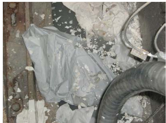
Selbst sehr große Papierreste wurden von der Zerhackerpumpe reibungslos angesaugt, zerkleinert und weitergefördert
