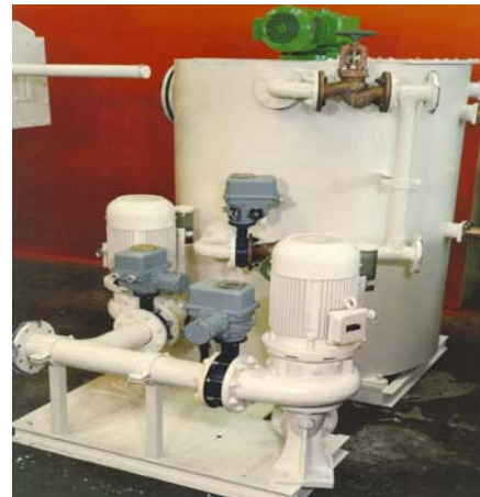
2 Stk. Pumpe ES-J für Zerkleinerung und Weitertransport von Speiserestabfällen aus Speiserestetank
